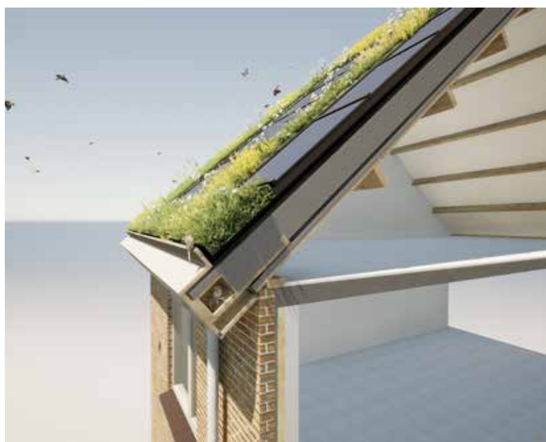
Het Roef-concept is een prefab module voor hellende daken, waarin isolatie, beplanting, waterberging, vogelnesten, 'insectenhôtels' en pv-panelen zijn geïntegreerd.
